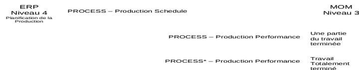
Exemple de transactions B2M tiré de la norme en cours d'approbation. Le système ERP envoie un programme de production, le MOM « Manufacturing Operation Management » rapporte le travail effectué. Le verbe ISA95 « PROCESS » permet de traiter des transactions « PUSH » qui place le possesseur de l'information en maître du processus d'échange.. (Les modèles PULL et PUBLISH sont également supportés)
